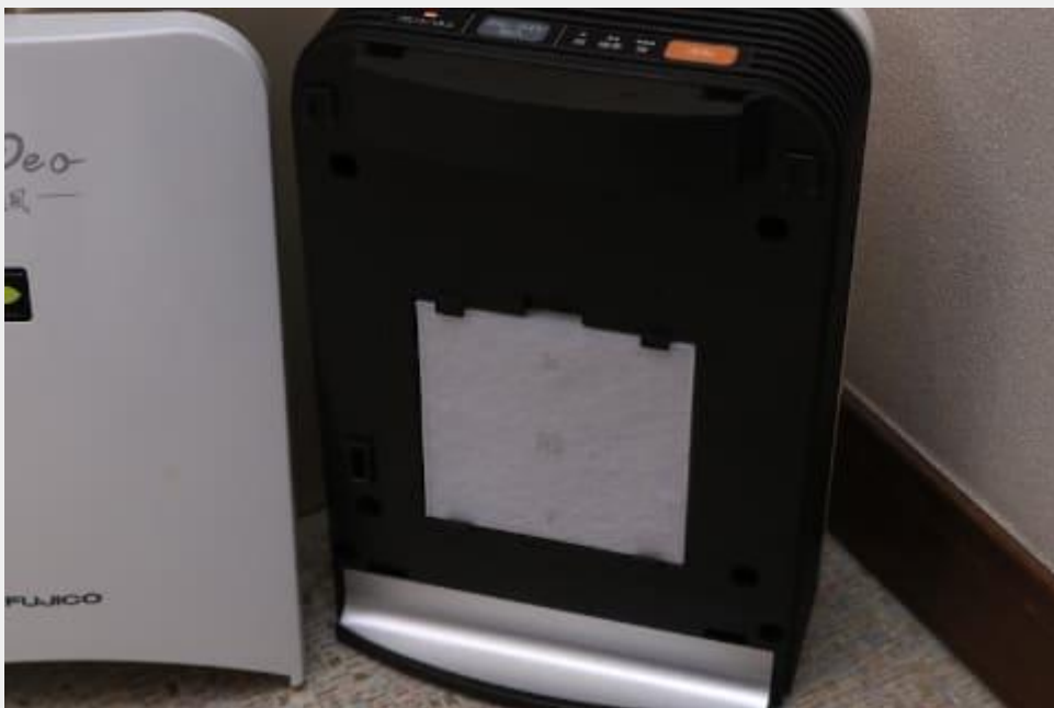
吸入口に設けられているプレフィルター。本格的な花粉や PM2.5 の除去には向いていない
